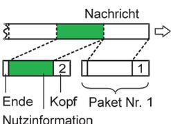
Eine Nachricht (Nutzinformation) wird mit einem Kopf (Adresse) und einem Ende (Kontrolle) versehen. Kopf, Nutzinformation und Ende bilden ein Paket. Die Pakete können eine feste oder eine variable Länge haben. Am Ziel entpacken berechnete Stationen die für sie bestimmte Information.
