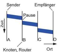
Informationen werden aufgeteilt, zwischengespeichert und dann auf verschiedenen Leitungen transportiert. Der Verbindungsaufbau beansprucht keine Zeit. Diese Vermittlungsart ist für Netze geeignet, in denen sporadisch kurze Informationen zwischen den Endeinrichtungen ausgetauscht werden müssen.
