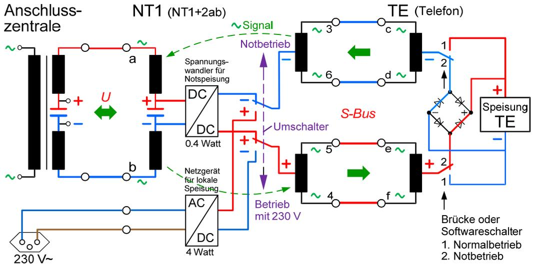
Die gleichzeitige Übertragung von AC und DC auf der U-Schnittstelle geschieht mittels Übertrager. Dank dem Kondensator zwischen den aufgetrennten Wicklungen lassen sich über die Zweidrahtleitung die folgenden Spannungen übertragen:
