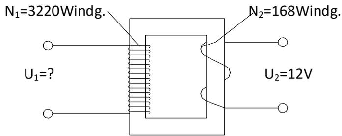
Berechnen Sie für diesen Einphasentransformator:
