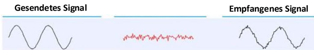
Im oberen Bild ist eine Signalübertragung dargestellt. Von der Signalquelle zum Empfänger wird das Signal verändert. Wie nennt man diese Veränderung und durch was wird diese hervorgerufen?
