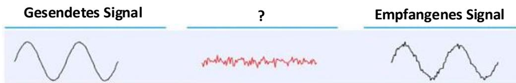
Im Bild oben ist eine Signalübertragung dargestellt. Von der Signalquelle zum Empfänger wird das Signal verändert. Wie nennt man diese Veränderung und wodurch wird diese hervorgerufen?
