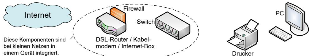
In der Regel wird für den Übergang ins WAN ein Router mit integriertem Modem verwendet. Der Switch teilt den Internetzugang unter mehreren PCs auf. Mit eingerichteter Firewall lässt sich das Netzwerk gegen Eindringlinge von aussen (Hacker) schützen.
