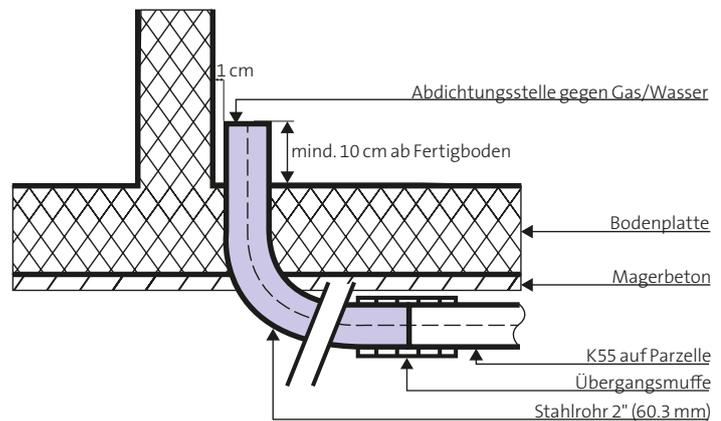
Unabhängig vom Zeitpunkt des Kabeleinzuges sind die Durchdringungen der Kabelschutzrohre im Entwässerungsschacht oder bei der Hauseinführung durch die Bauherrschaft jederzeit gas- und wasserdicht zu erstellen bzw. abzudichten. Eine Haftung von Swisscom für Schäden im Zusammenhang mit einer unsachgemässen Realisierung wird, soweit gesetzlich zulässig, ausgeschlossen.
