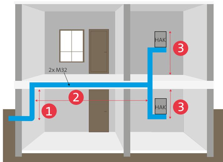
Das Kabeltrasse von der Gebäudeeinführung bis zum HAK hat die Auflagen der VKF zu erfüllen und ist in drei Bereiche unterteilt.
